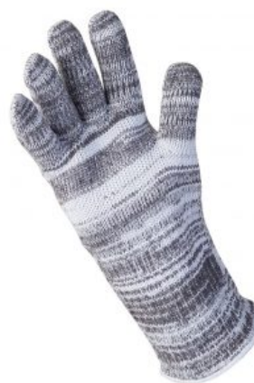
Modelo Berotex C-5 36 cm.(corte 5) RIESGOS MECÁNICOS EN 388 /Corte 5 Modelo "Berotex C-5 36 cm." 2542 X231XX - Anticorte nivel 5 - Anticalórico - 250°C 36 cm ... Ver modelo
